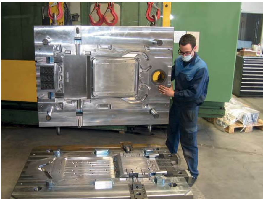
Stampo per pressofusione d'alluminio per pressa da 1.600 t.
