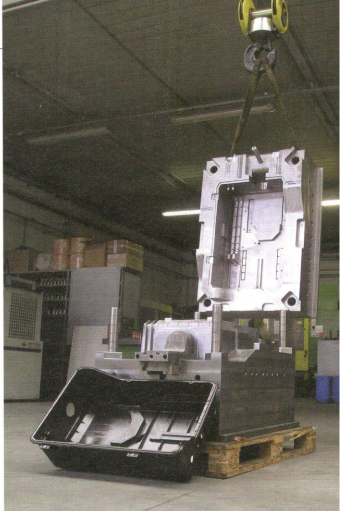
Stampo di medie dimensioni realizzato da AL.MA. Stampi per copertura integrale di caldaia a condensazione in materiale termoplastico.
