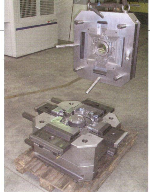
Stampo di medie dimensioni con quattro movimenti realizzato da AL.MA. Stampi per la pressofusione di un corpo per motoriduttore.
