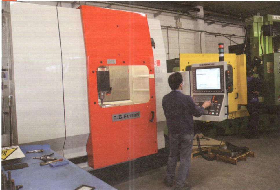
Ultimo arrivato in AL.MA. Stampi, il centro di lavoro verticale B156 è ideale per effettuare lavorazioni di precisione di particolari tecnici, elettrodi, tasselli e stampi.
