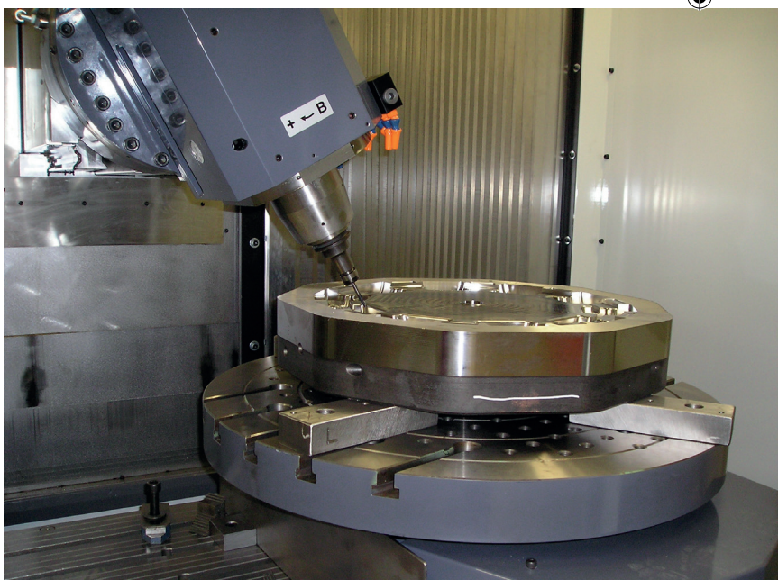
Lavorazione di finitura di una matrice per pressofusione sul centro di lavoro GT 2000.
