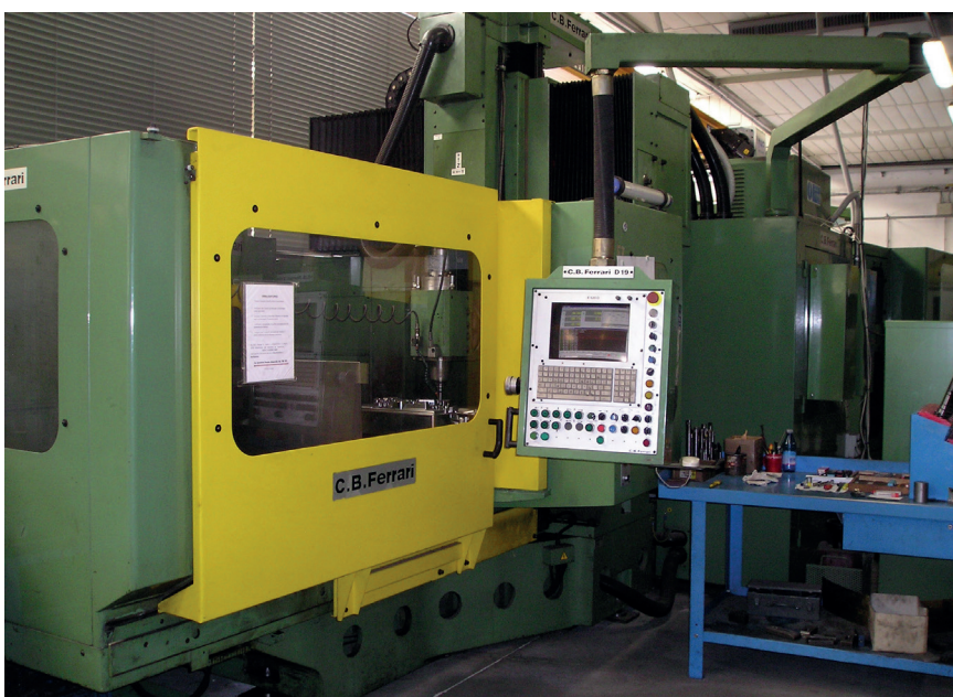
Lavorazione di finitura di una matrice per pressofusione sul centro di lavoro GT 2000.
