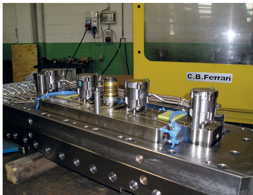
Vista parziale di uno stampo con canale caldo a quattro punti di iniezione ad otturazione per plafoniera di grandi dimensioni.
